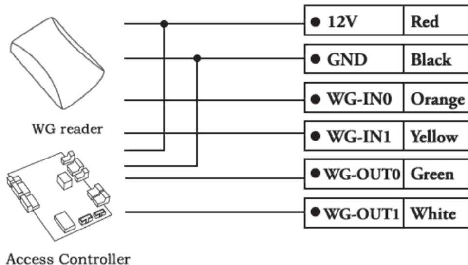
**Примечание:** Когда источник питания контроллера недостаточен (устройство может автоматически отключиться при распознавании лиц). В этом случае, пожалуйста, выполните требования подключения, как показано на схеме ниже:
