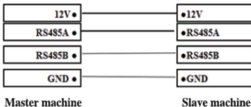
**Примечание:** Когда источник питания контроллера доступа недостаточен (устройство может автоматически отключиться при распознавании лиц). В этом случае, пожалуйста, выполните требования подключения, как показано на схеме ниже:
